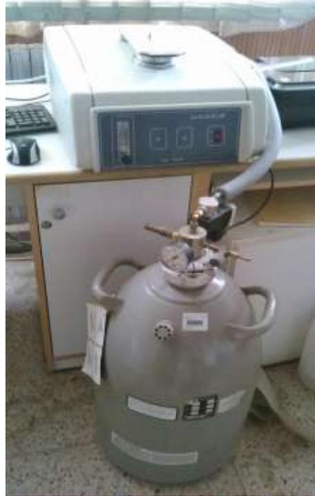
الشكل (8). صورة جهاز التحليل الحراري الماسح المقارن المستخدم.
